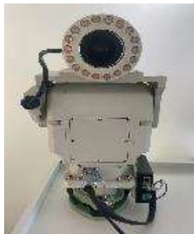
高精密光学多相阵空间定位与测量系统
