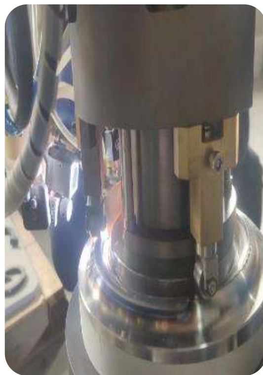
控制棒驱动机构小Ω环密封焊 (经鉴定国内领先)
