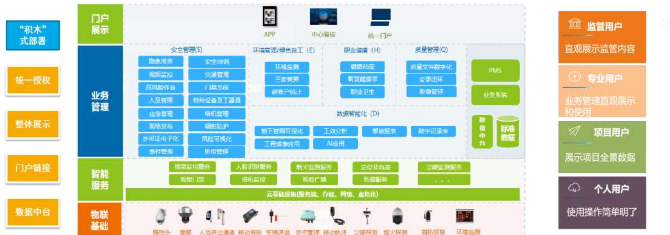
三澳核电智慧工地整体架构图
