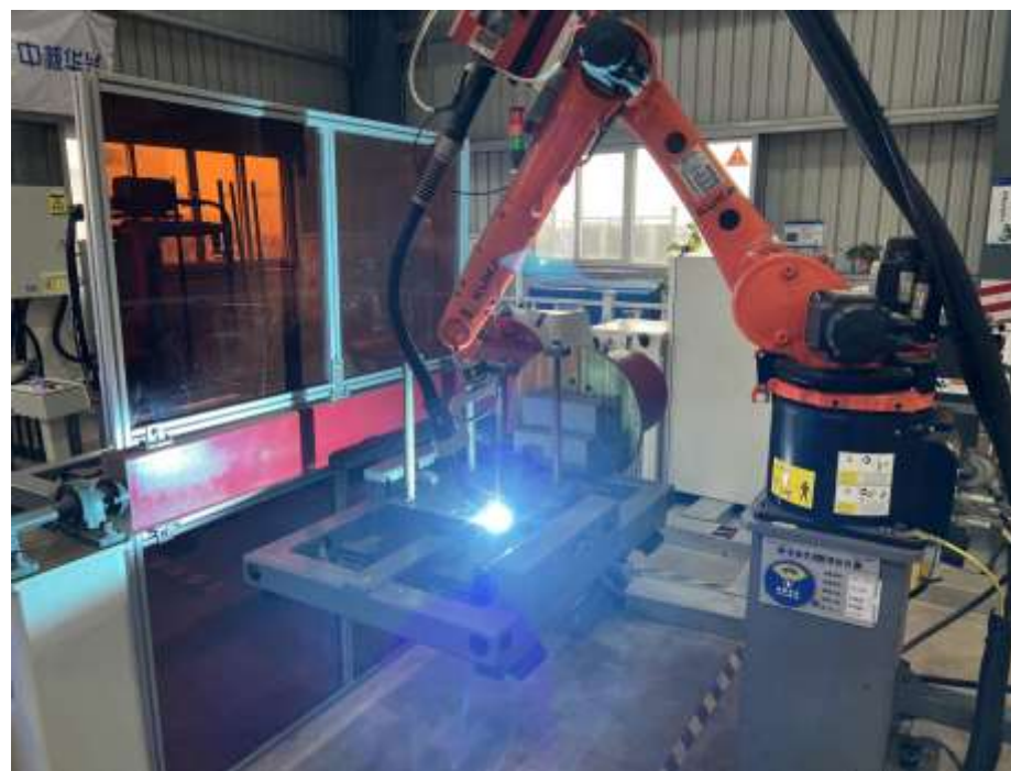
预埋件机械手臂自动焊：：定位准确、延时准确、成型均匀、连续工作、焊缝质量稳定。
