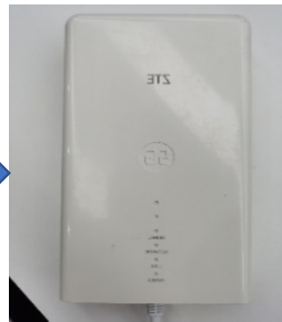
CPE ( 5G转换装置 ) 插5G专用物联网卡
