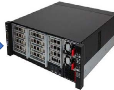
MEC ( 边缘计算服务器 ) 与5G专用物联网卡绑定，数据信息 直接分流至公司内网
