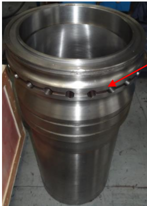
高温区钻孔冷却，提高冷却性能
