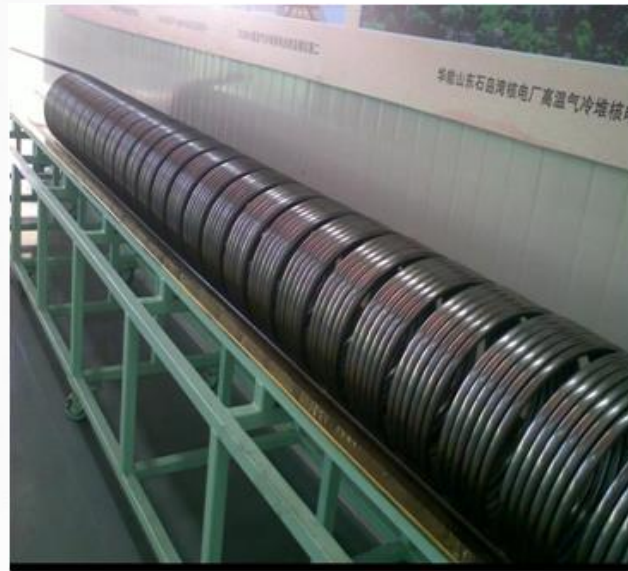
单根60m长T22传热管，多头 成型螺旋盘管
