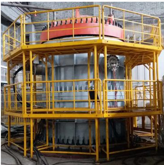
世界首台套电磁轴承支撑的大 功率立式主氮风机首次应用
