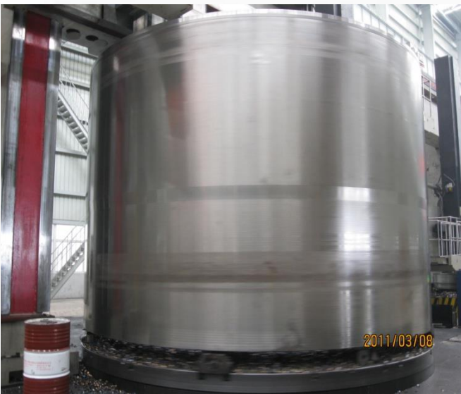
460吨的反应堆压力容器下 筒体1特大锻件制造成功
