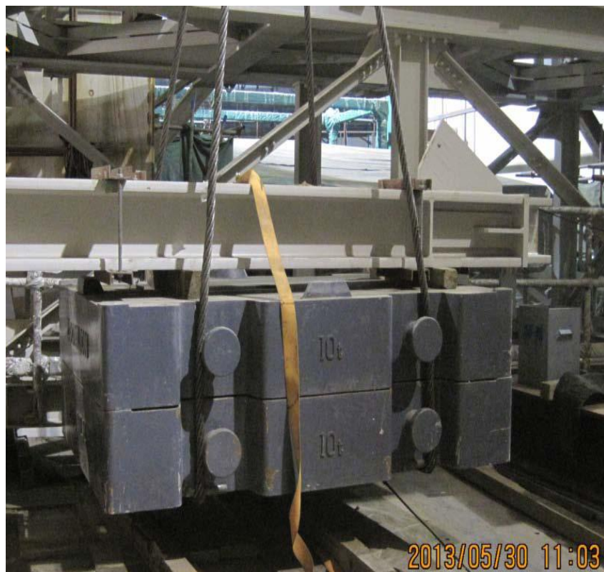
环吊副钩紧急下落载荷试验
