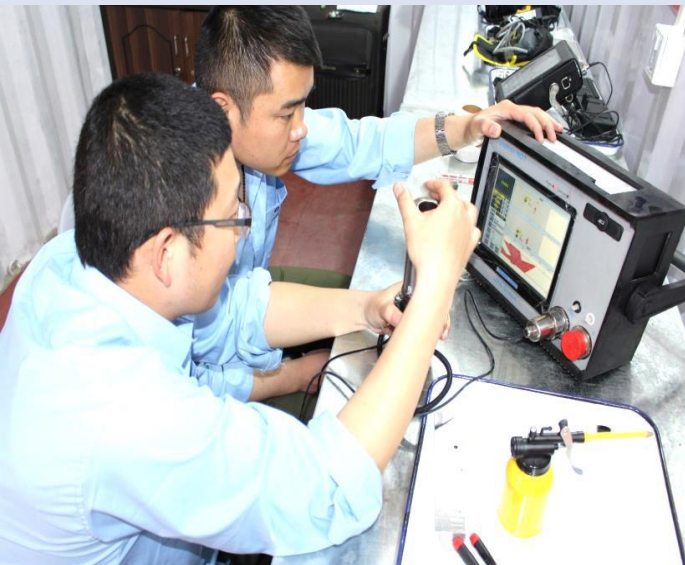
相控阵检测仪器调试 检测仿真
