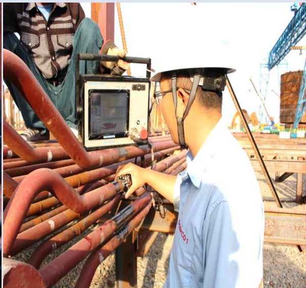
相控阵超声检测技术现场应用
